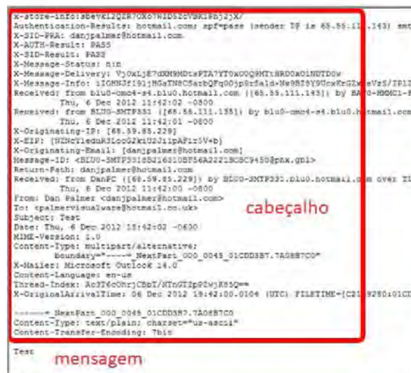
Figura 15: O cabeçalho do e-mail é essencial para a análise da perícia, pois detém várias informações sobre o remetente da mensagem
